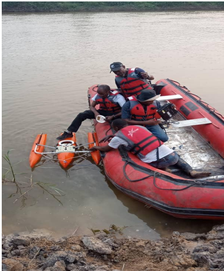
Figure 6. Dispositif utilisé (ADCP embarqué sur trimaran) lors de la prise des mesures
