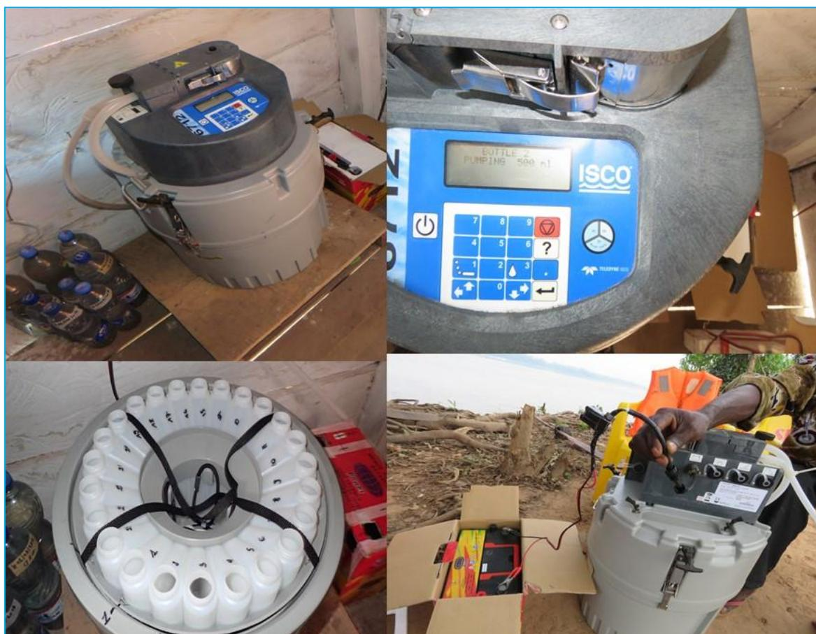
*Figure 8. Quelques équipements de la station de surveillance des flux sur la rivière Kasai*
